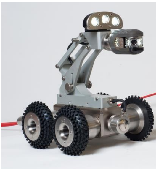
Робототехнический комплекс FWL 100 Самоходный телеинспекционный
